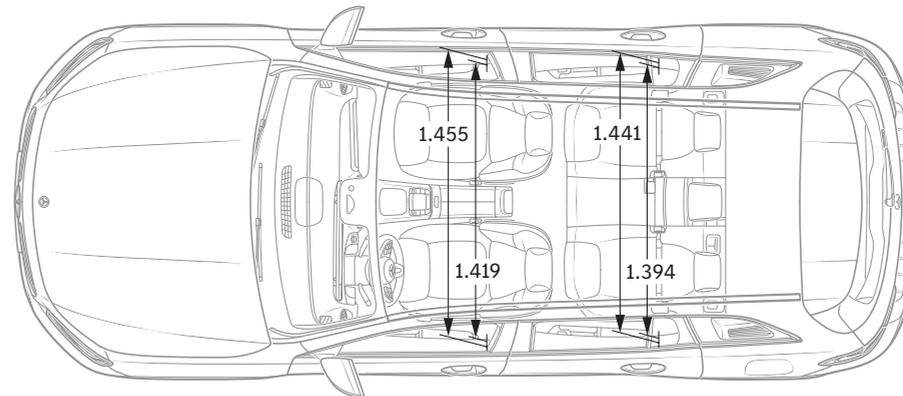
Alle Angaben in Millimetern. Die abgebildeten Masse sind Mittelwerte. Sie gelten für Fahrzeuge in Grundausstattung und in unbelastetem Zustand.
