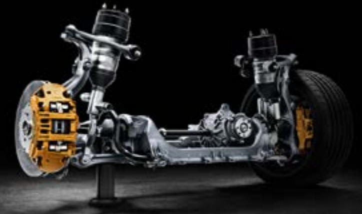
AMG RIDE CONTROL+ Fahrwerk (489)
